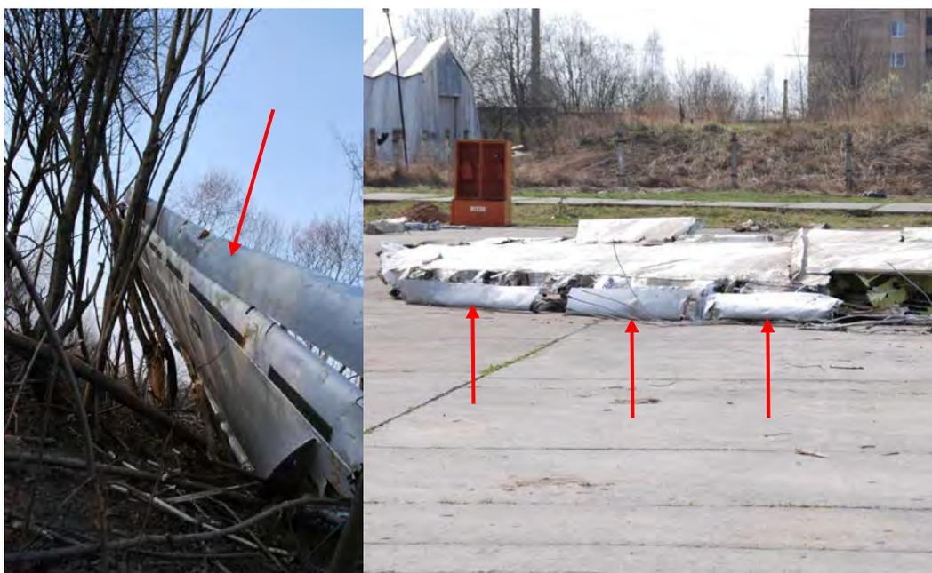
Рис. 7. Выпущенные предкрылки левого и правого крыла самолета
