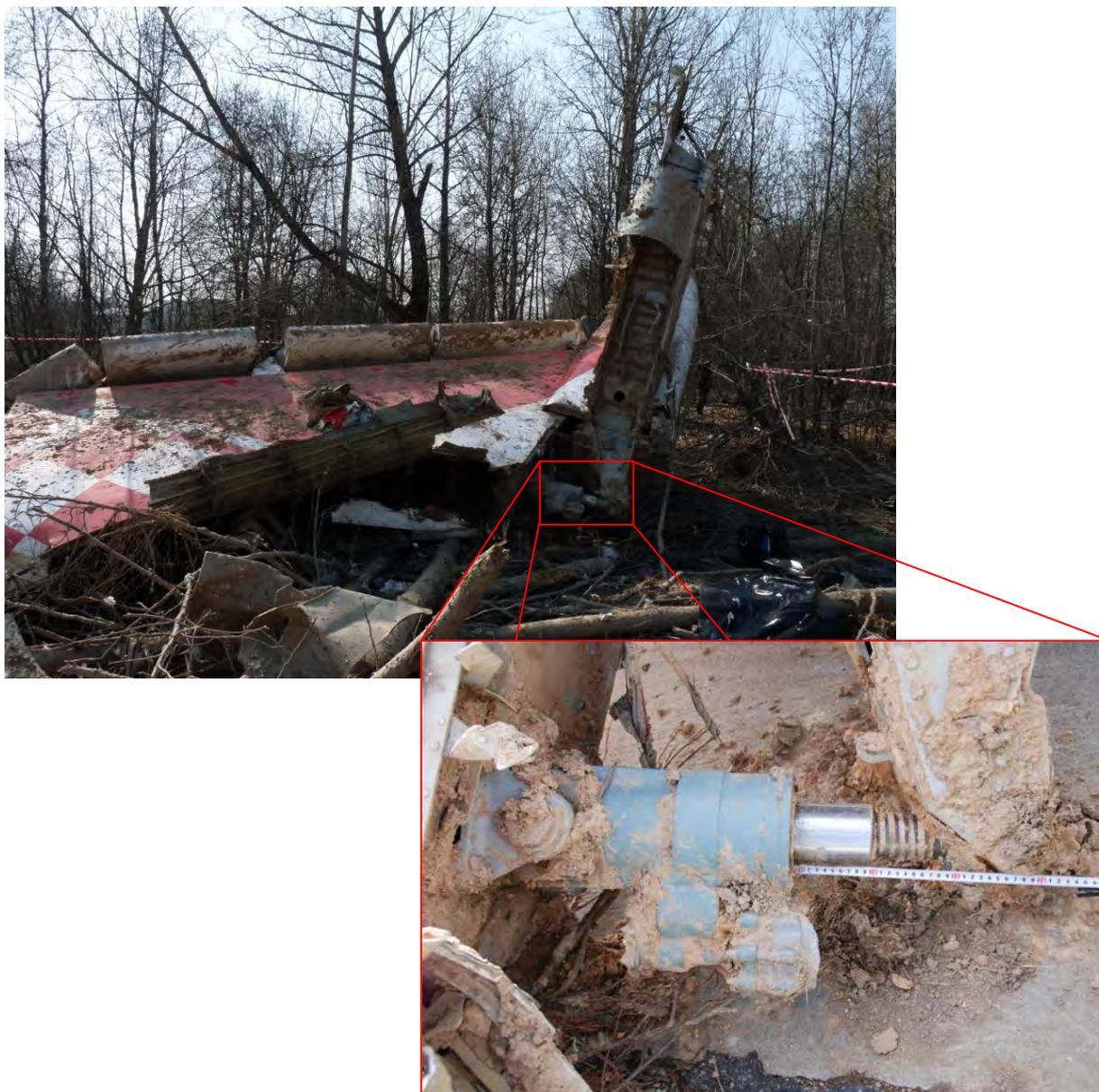
Рис. 14. Стабилизатор установлен на угол  $-3^\circ$
