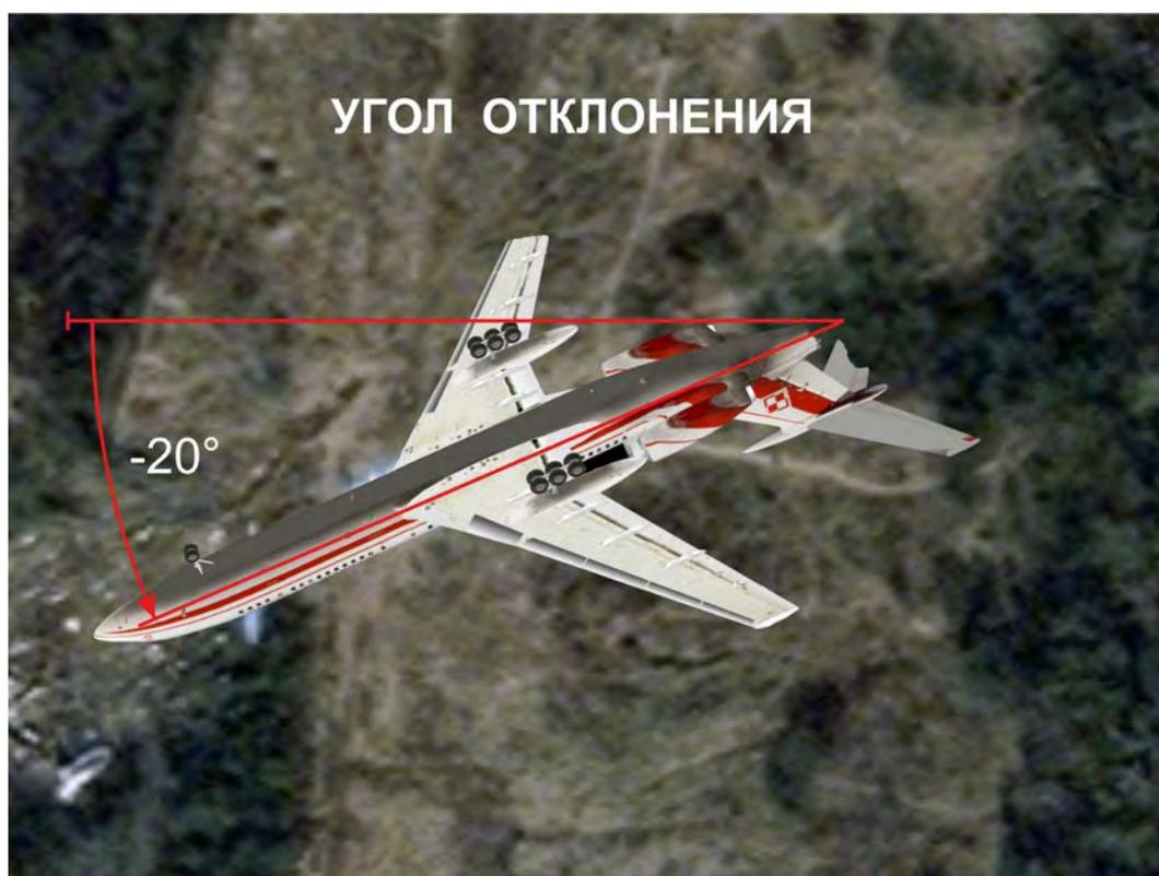
Рис. 17. Угол отклонения самолета в момент столкновения с землей
