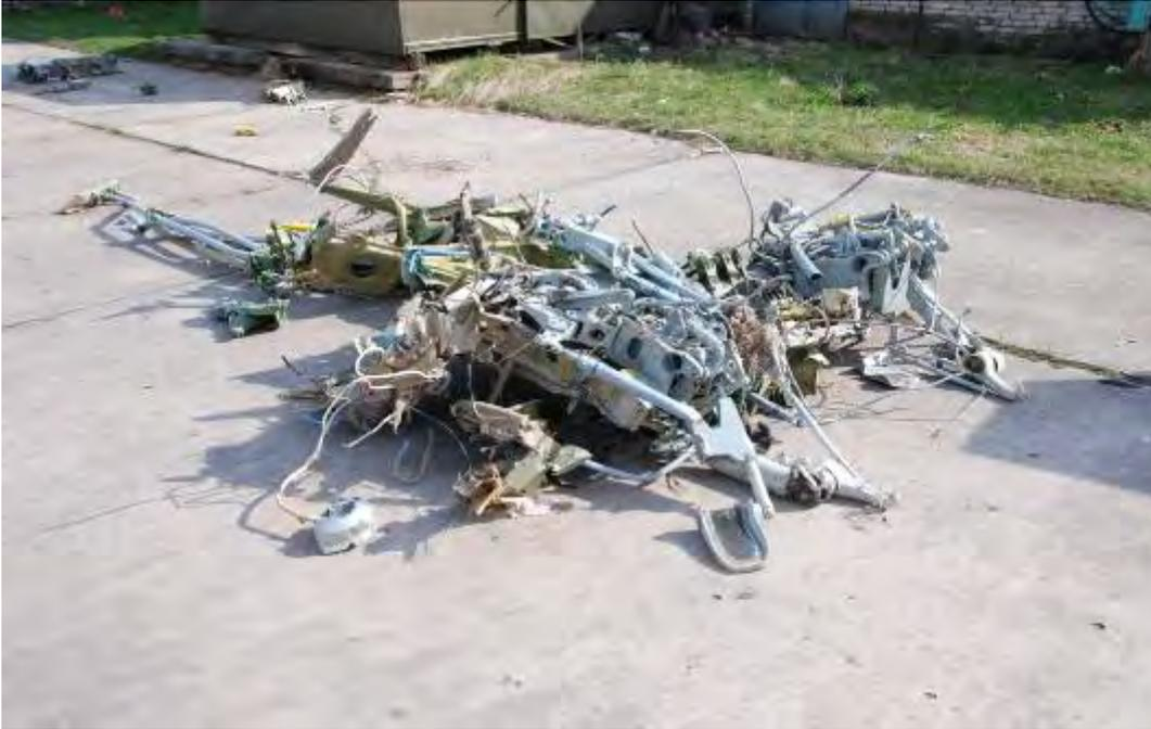
Рис. 26. Оставшиеся части системы управления самолетом - элементы, встроенные в кокпите и под полом кабины экипажа.
