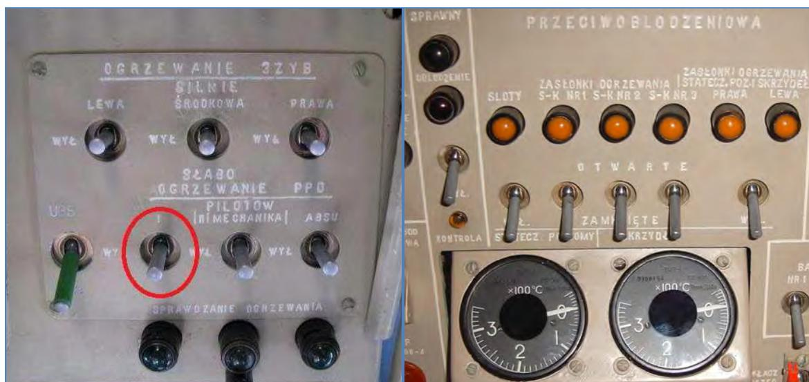
Рис. 23. Панель управления включением и проверкой системы обогрева ПВД (слева), а также панель управления системой противообледенения (справа) самолета ТУ-154М
