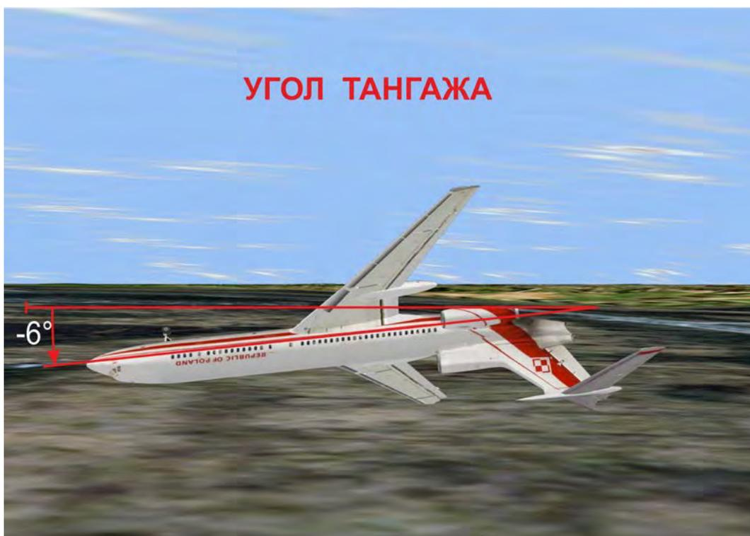
Рис. 16. Угол тангажа самолета в момент столкновения с землей
