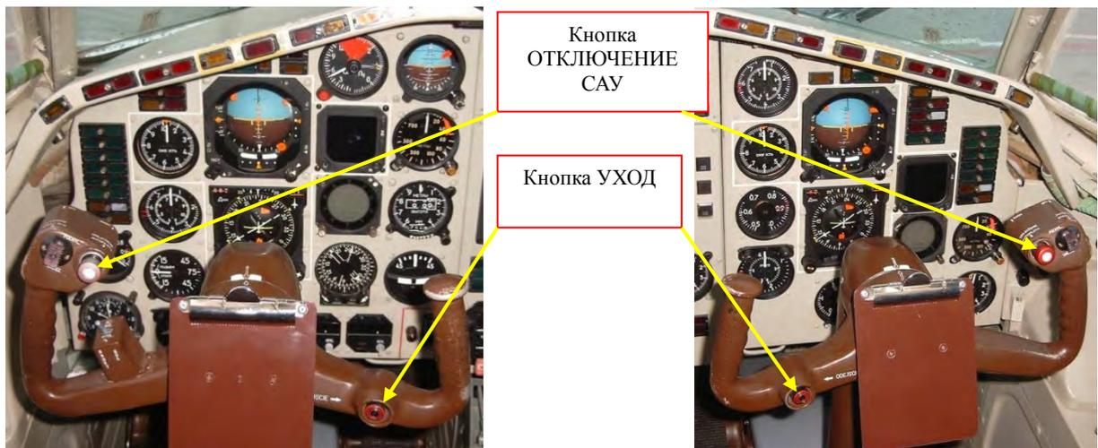
Рис. 13. Размещение кнопок управления САУ на штурвалах
